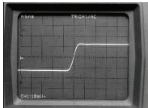
Bild 1C Darstellung Analogoszilloskop mit CRT-Schirm. Signal: 1z Rechteck, Oszilloskop-Einstellung: Y-Ablenkung 10 mV/cm, X-Ablenkung 5 ns/cm. Einwandfreies Rechtecksignal.
